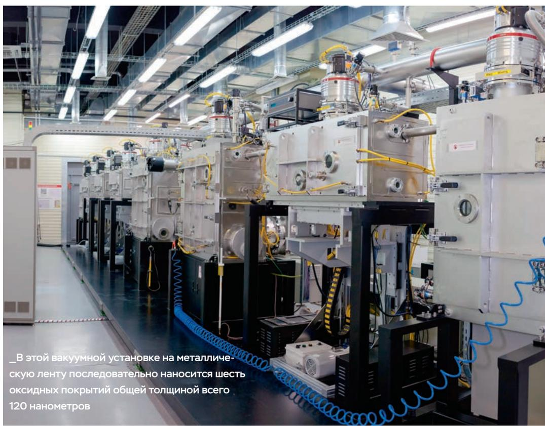
«В этой вакуумной установке на металлическую ленту последовательно наносится шесть оксидных покрытий общей толщиной всего 120 нанометров»
